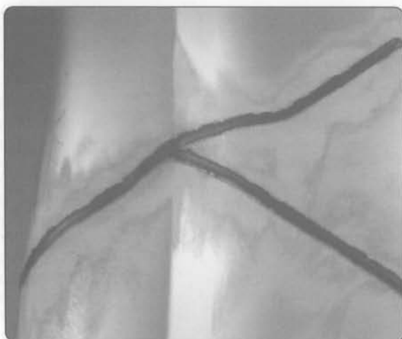
Сварной шов должен немного выступать и быть гладким.
